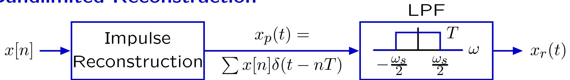
**Sampling Theorem:** If  $X(j\omega) = 0 \ \forall |\omega| > \frac{\omega_s}{2}$  then  $x_r(t) = x(t)$ .
