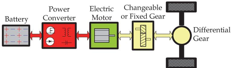
Fig. 6. One-motor BEV
