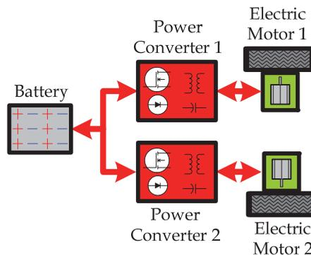
Fig. 7. Two-motor BEV
