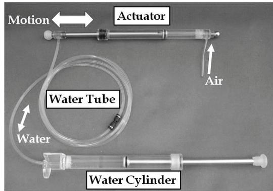
Fig. 8. Hydraulic linear actuator
