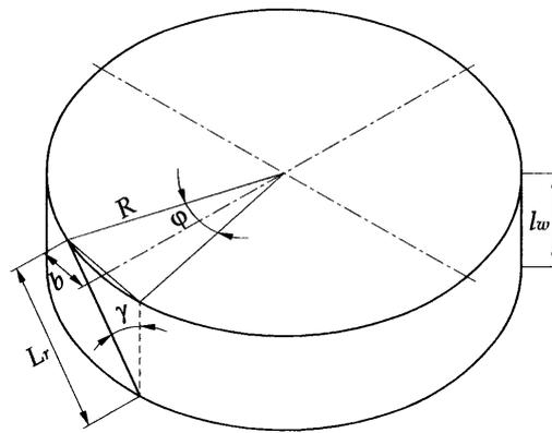
Figure 12. Wheel parameters
