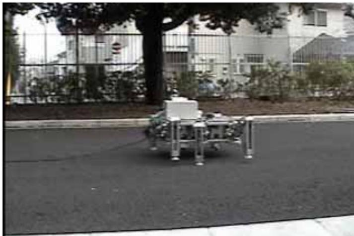
Figure 17. Tripod gait walking (Huang, Q. et al, 2007)
