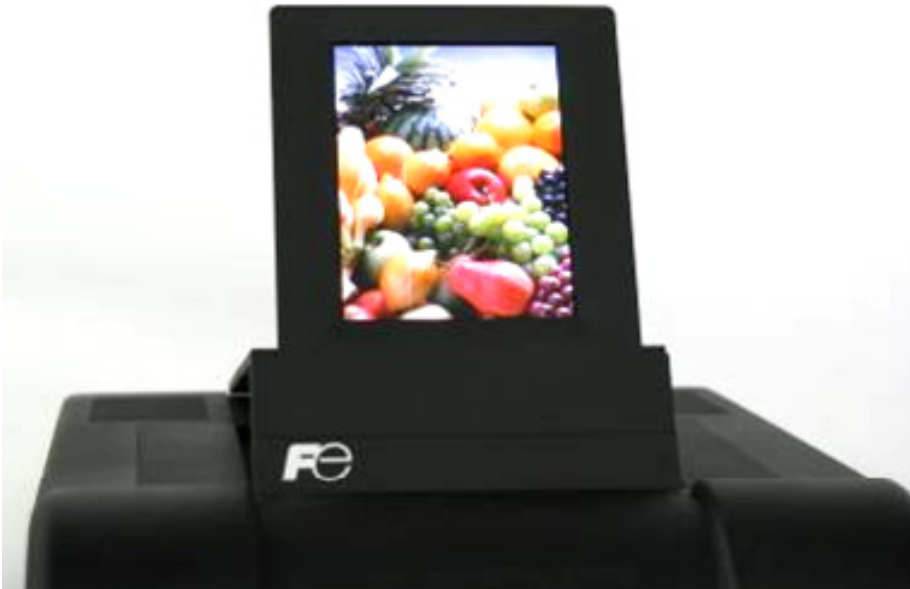
Fig. 20. 2.8" a-Si TFT AM-OLED display.
