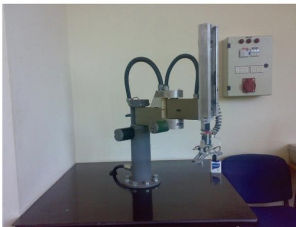
Fig. 17. SCARA-type robot, DIE-USACH
