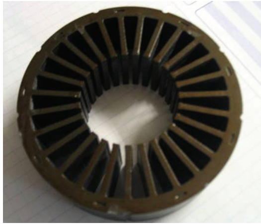
Fig. 8. EM stator assembled from thin metal plates
