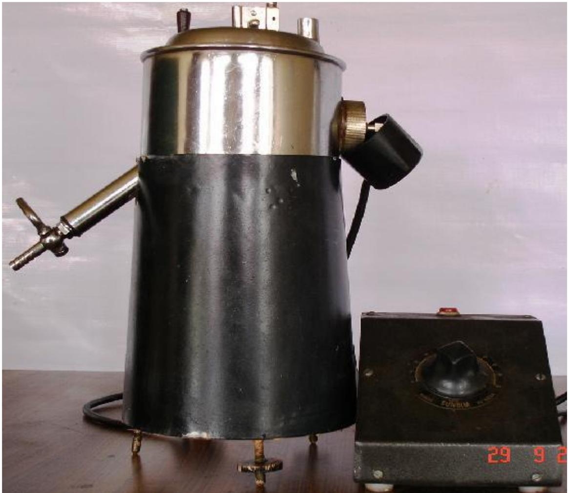
**Fig: Redwood Viscometer Apparatus**
