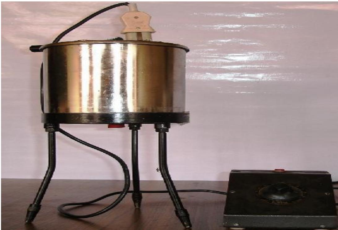
**Fig: Saybolt viscometer Apparatus**
